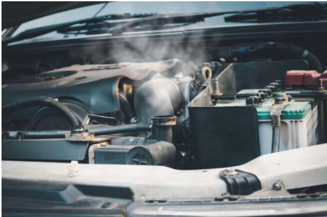
**Prolite** – Kebocoran air radiator dapat menjadi masalah serius bagi kendaraan Anda, karena dapat menyebabkan kerusakan yang cukup parah pada mesin dan sistem pendingin. Tanpa perawatan yang tepat dan perbaikan yang cepat, kebocoran ini dapat
