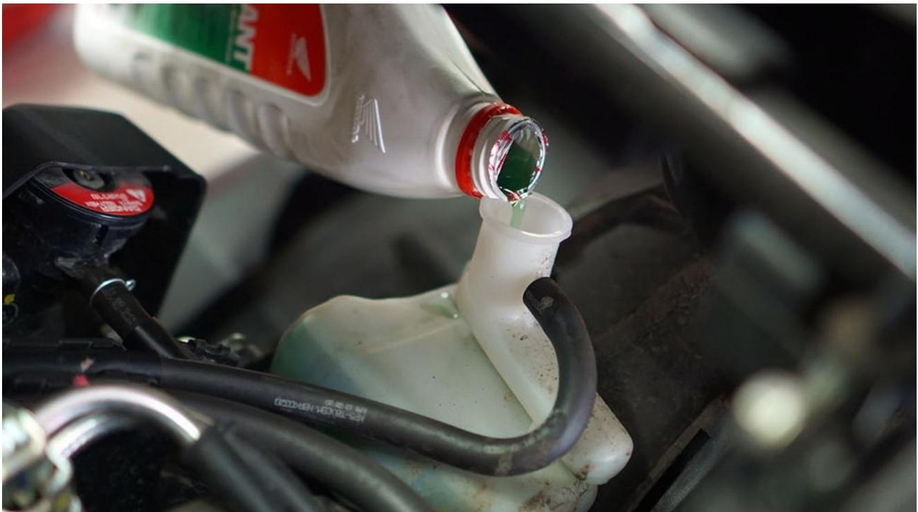
**Prolite** – Indikator suhu berfungsi untuk memberikan informasi kondisi suhu mesin sepeda motor. Ada beberapa jenis sistem pendinginan mesin sepeda motor, diantaranya pendinginan menggunakan cairan, pendinginan oli dan pendinginan hembusan udara secara langsung. Nah, produk skutik terbaru Honda sudah dilengkapi sistem pendingin cairan atau yang lebih kita kenal dengan nama radiator.
