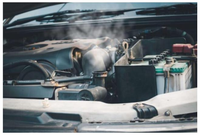
Prolite — Kebocoran air radiator dapat menjadi masalah serius bagi kendaraan Anda, karena dapat menyebabkan kerusakan yang cukup parah pada mesin dan sistem pendingin. Tanpa perawatan yang tepat dan perbaikan yang cepat, kebocoran ini dapat menyebabkan kerusakan yang permanen dan menyebabkan biaya perbaikan yang sangat tinggi. Selain itu, kebocoran air radiator dapat menyebabkan mesin overheat dan meningkatkan konsumsi bahan bakar. Berikut adalah dampak dari kebocoran air radiator mobil:
