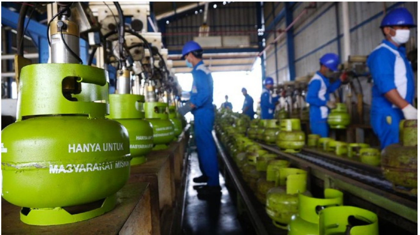
Pekerja melakukan sejumlah tahap pengisian LPG pada tabung 3 Kg di SPBE - CNBC
